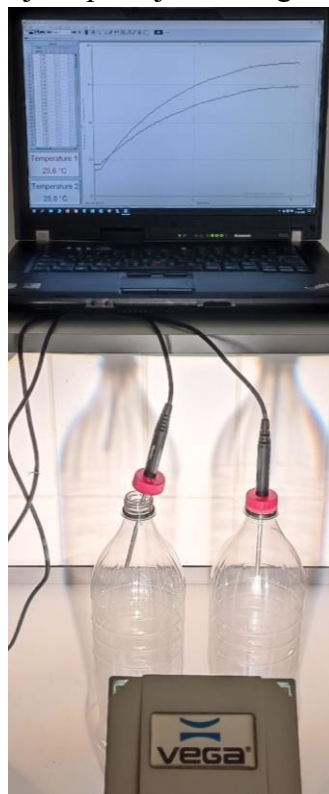
SLIKA 1: Postavitev dveh plastenk in računalnika pred grafoskopom. Svetloba iz grafoskopa predstavlja »Sonce« - vir svetlobe in sevanja.
