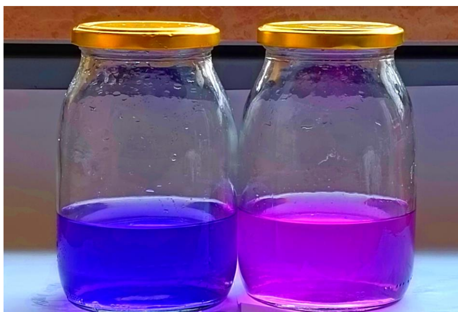
SLIKA 14: Indikator kislin je sok rdečega zelja. Levo brez dodanega CO 2 in desno z absorbiranim CO 2 .
