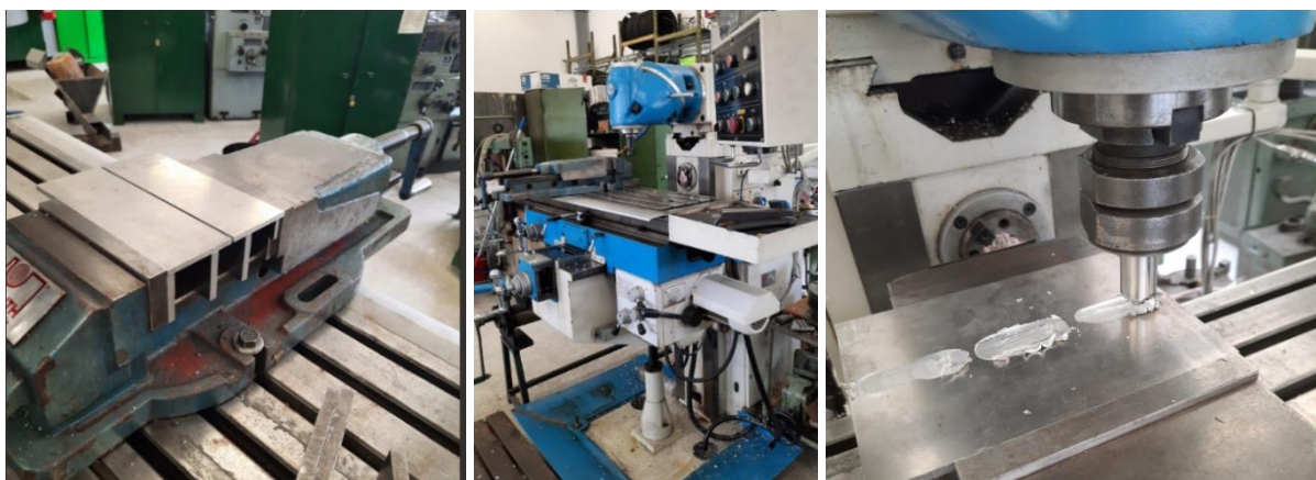
SLIKA 6: Aluminijevi plošči (levo) smo zavarili na frezalnem stroju (sredina) pri dveh različnih hitrostih orodja in pri konstantnem podajanju (desno).
