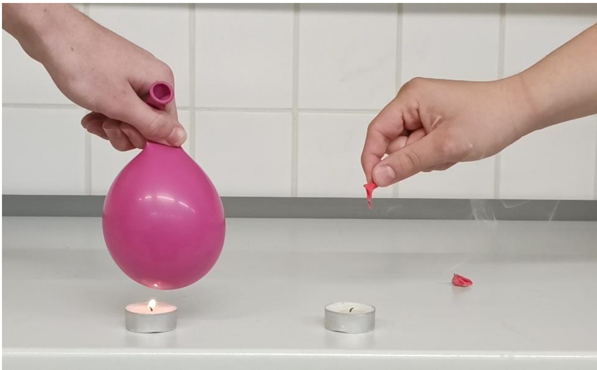
SLIKA 10: Vodni balon (levo) ne počí pri segrevanju. Zračni balon (desno) počí takoj.
