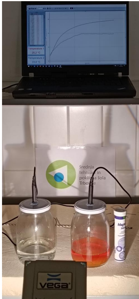
SLIKA 3: Postavitev dveh zaprtih kozarcev in računalnika pred grafoskopom. V desnem kozarcu je dodana obarvana šumeča tableta Mg, da je atmosfera v njem dodatno obogatena s CO 2 . V levem kozarcu je samo voda enake mase. Termometra sta na pokrovček zatesnjena z vročim silikonom, da zrak ne uhaja iz kozarcev.
