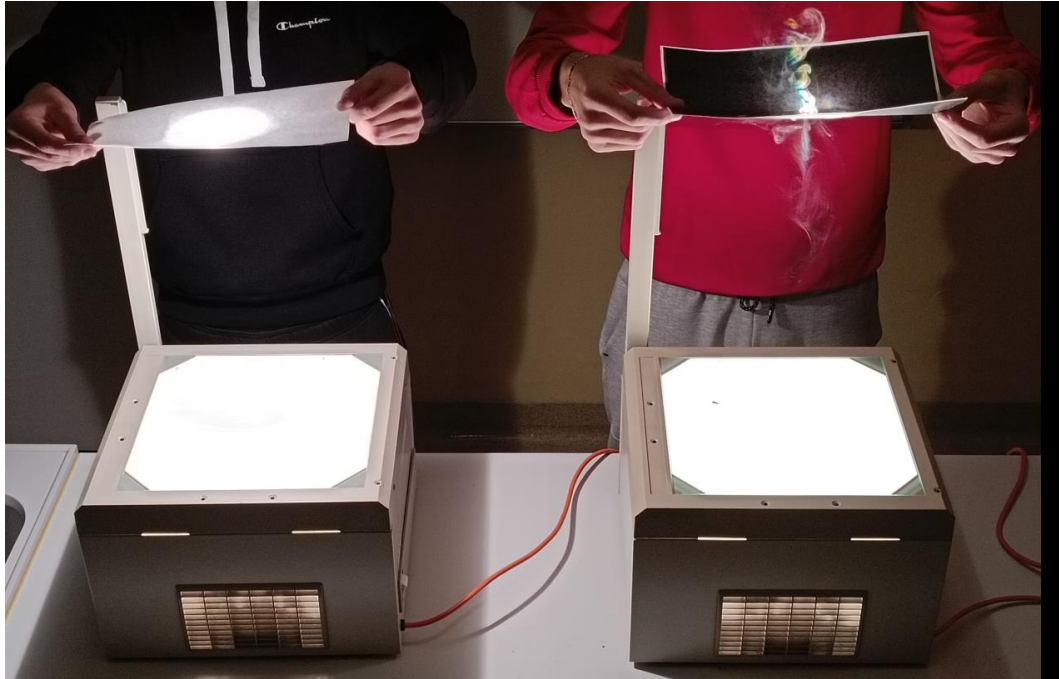
SLIKA 7: Obsevanje belega in črnega lista s svetlobo iz enakih grafoskopov. Oba lista sta na višini gorišča leče in sta obsevana enako časa. Desno vidimo, da se je počrnjen list vžgal in kasneje je v njem nastala luknja.
